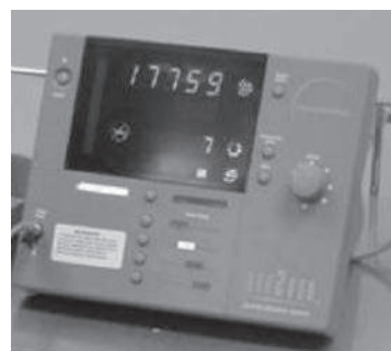
Figura 3. Medición de la radioactividad ex vivo mediante la sonda gamma laparoscópica.
